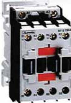
کنتاکت آینه ای یکی از انواع کنتاکت کمکی است که در کنتاکتورهای Lovato استفاده می باشد . این کنتاکت به گونه ای عمل می کند که وقتی یک کنتاکت NO بر اثر یک خطأ بسته می شود و این خطأ باعث بی برق شدن بوبین کنتاکتور شود ، تیغه آینه ای NC نمی تواند بسته شود از این قابلیت برای تشخیص خطأ و جلوگیری از آسیب بیشتر به سیستم استفاده می شود .
